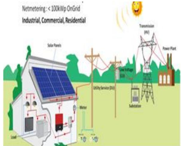
Fig.: Solar-Rooftop Power Plant
