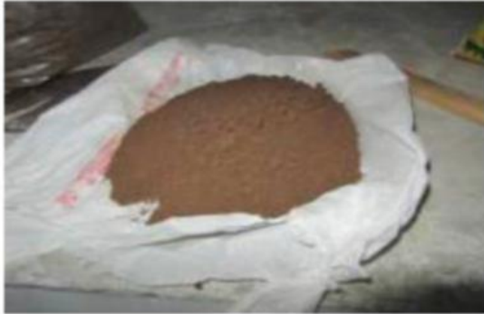
Fig 1 ETP Sludge of TiO 2
