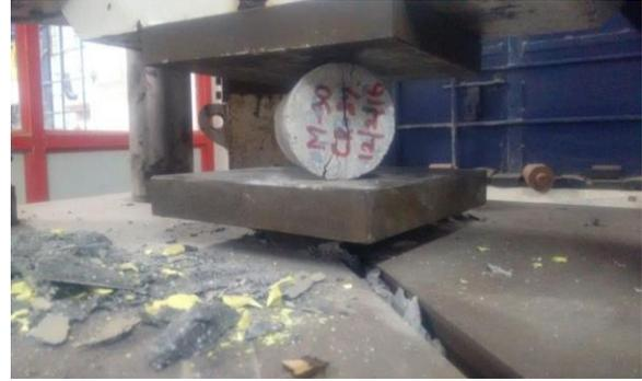
Fig 5: Split tensile test
