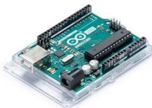
Fig 3(e) Arduino Uno
