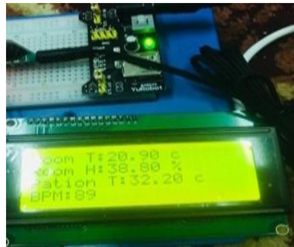
Fig. 7: Sensor Values displayed on LCD
