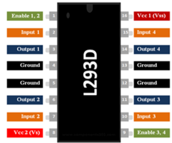
Fig3 L293D IC Pin Out
