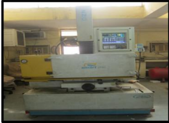
Fig. 1. ZNC EDM Machine (105/06-07)
