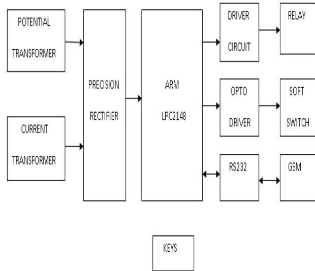
FIG 2.1 BLOCK DIAGRAM OF SOFT STARTER
