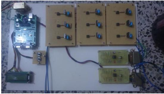
**FIG 3.1 THREE PHASE SOFT STARTER**
