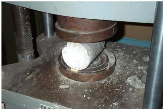
Fig II Split Tensile Test
