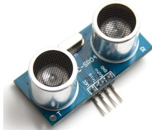
Fig 4.7) Ultrasonic Sensor
