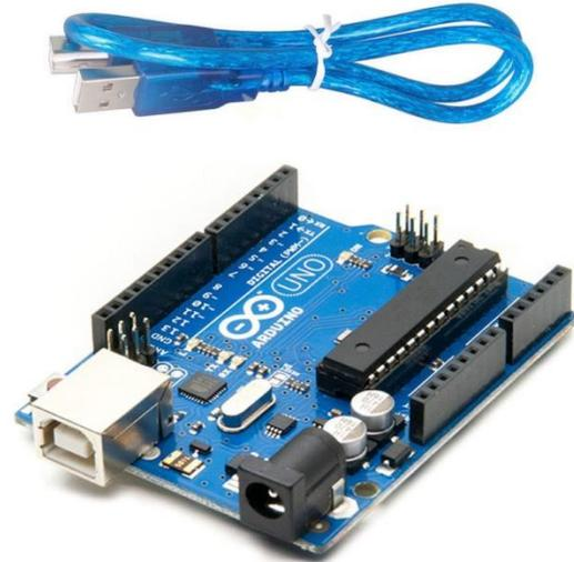
Fig4.1) Arduino Uno R3 Module
