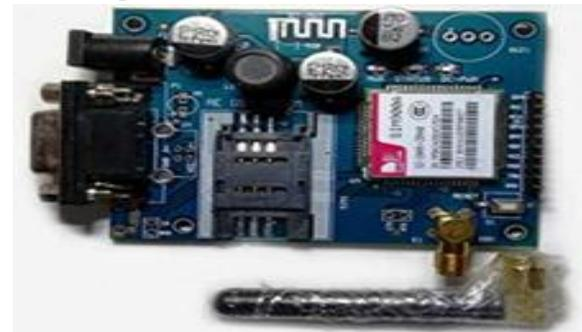
Fig 3 GSM module
