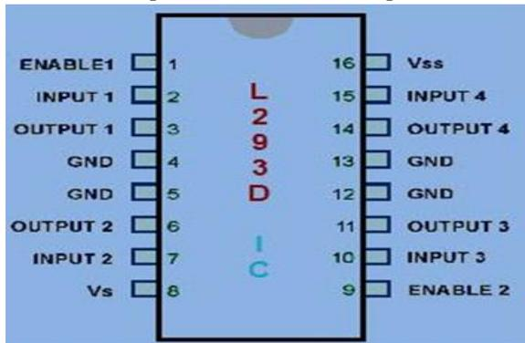
fig 2. Motor Driver IC
