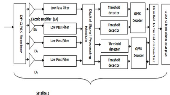
Figure 2 (d) Internal structure of DP-QPSK Receiver
