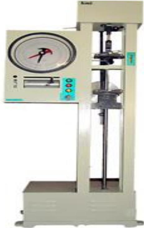
Fig. 2. Tensile Tester [4]
