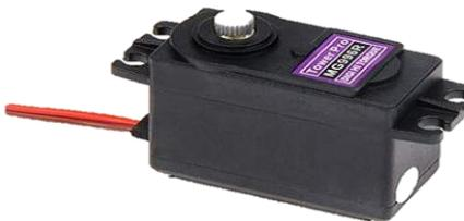
Fig3. Servo Motor
