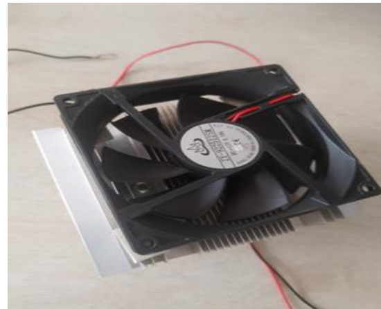
Fig.7:-DC Cooling Fan
