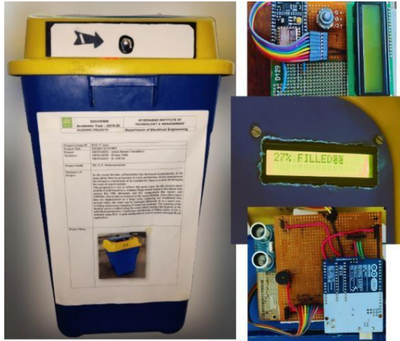
Fig. 2. Smart dustbin setup
