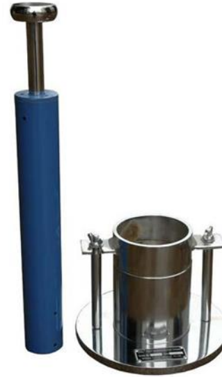
Fig 3.1.Modified Proctor test apparatus
