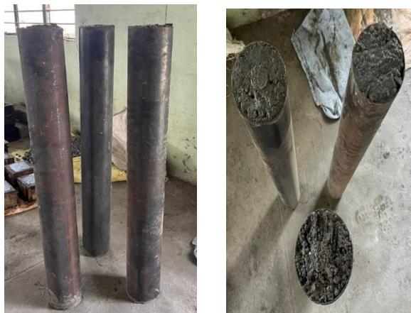
a) CFST columns
