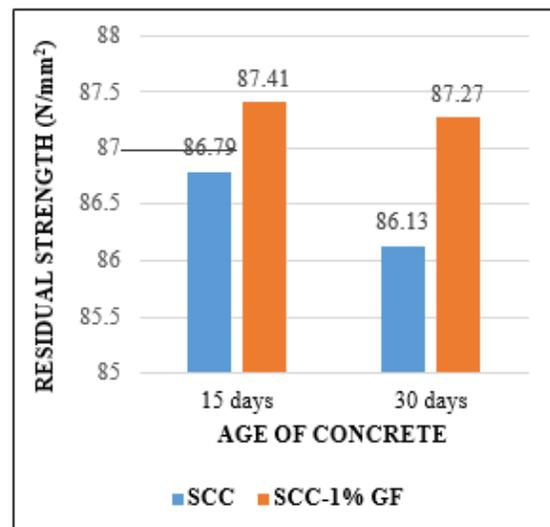
FIG 5 LOSS OF COMPRESSIVE STRENGTH AFTER SULPHATE ATTACK (Na<sub>2</sub>SO<sub>4</sub>) GRAPH
