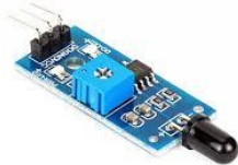
E. Fire Sensor
